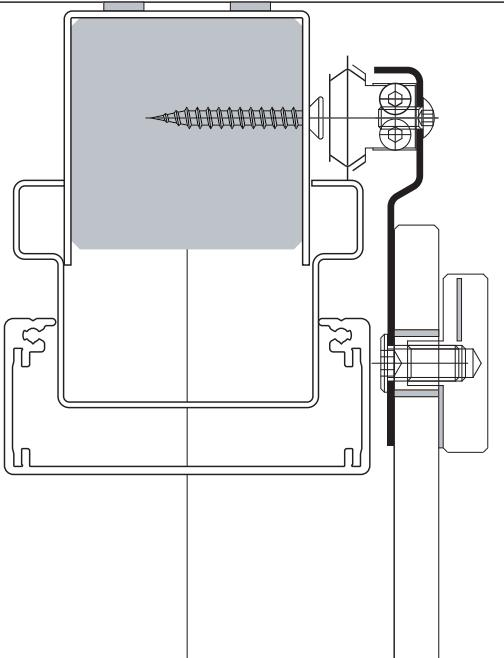
**Maars Schiebetüren** - eine ästhetische Ergänzung unseres Türenprogramms. Eine Schiebetür die mittels einer speziellen und sehr schlanken Konstruktion in Edelstahl auf störende und meist überdimensionierte Abdeckblenden verzichtet. Das Schiebelement wird nahezu flächenbündig vor der Systemwand bewegt, und ist als Ganzglastür oder Glasrahm-tür – einfach oder doppel Tür - Metall- oder Holztür lieferbar. Sie kann bei den Wandtypen Intersign, Metaline String und String2 eingesetzt werden.
